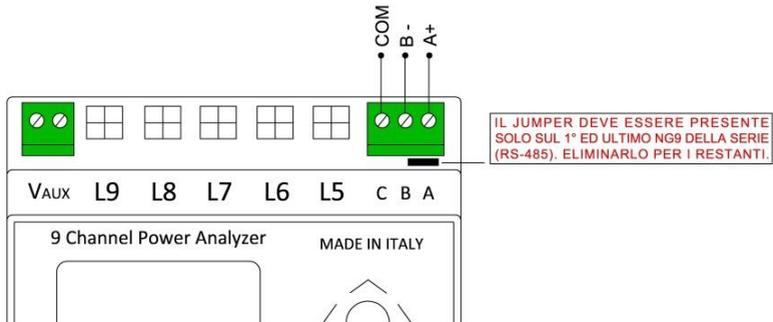
Sotto, viene proposta l'immagine del cablaggio della seriale RS485 di un NG9/96
