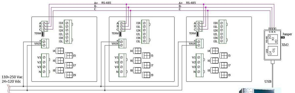
Esempio di collegamento di Nr. 3 NG-9/96 mediante RS-485, interfacciati al PC dal convertitore XM2 RS-485 /USB. I Jumper vengono inseriti nei moduli situati alle due estremità della linea: in questo caso sono l' NG-9/96 e l' XM2.
