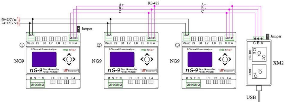
Esempio di connessione di Nr.3 NG9 mediante RS-485, interfacciati al PC dal convertitore XM2 RS-485 /USB. I Jumper vengono inseriti nei moduli posti alle estremità: in questo caso NG9 (1) e XM2.
