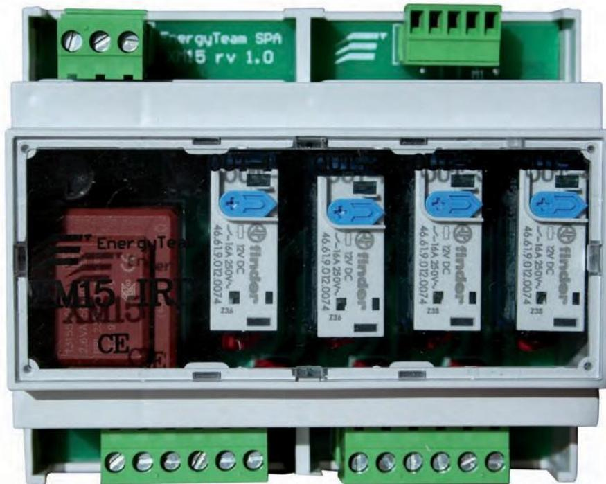
L'apparato X-Meter offre in uscita 4 attuazioni ON-OFF capaci di pilotare 4 uscite a tensione massima 24Vac/Vdc e corrente, massima 100mA cadauno. Per poter utilizzare tali uscite per pilotare carichi standard inseriti in rete monofase 220Vac occorre interfacciarle al modulo XM15.
