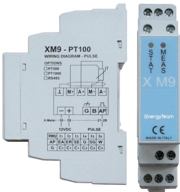
Il dispositivo XM9 permette di leggere una temperatura mediante una sonda PT100, PT500 oppure PT1000 e di convertirne il valore letto in uscita impulsiva con frequenza compresa tra 0Hz e 5Hz. In particolare il valore minimo della scala di misura implicherà un impulso di uscita di frequenza 0Hz (0 impulsi al secondo) mentre il fondo scala comporterà un impulso d'uscita a frequenza 5Hz (5 impulsi al secondo).
