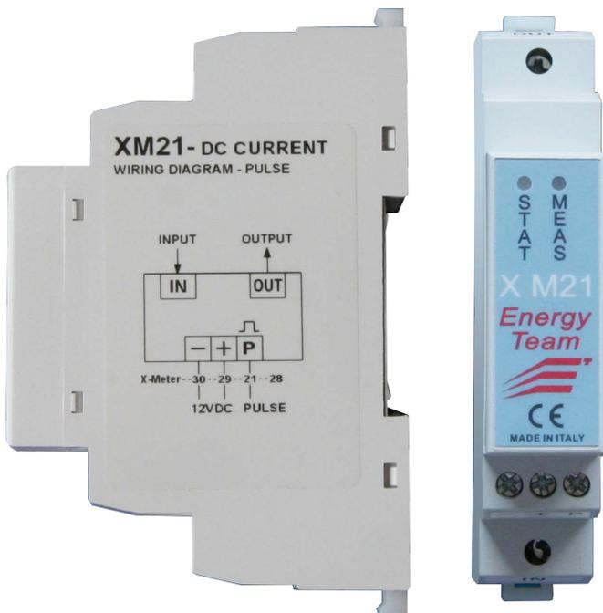
Il dispositivo XM21 permette di misurare la corrente generata da una stringa e di convertirla in segnali impulsivi 0...5 Hz compatibili con lo standard dei segnali di ingresso delle piattaforme CM2 SOLAR o XRWU GOLD/XMETER.
